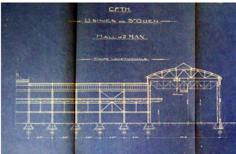
Coupe de l'atelier de montage. Deux grands ponts roulants parcourent toute la halle, AM Saint-Ouen, PC 21W45
